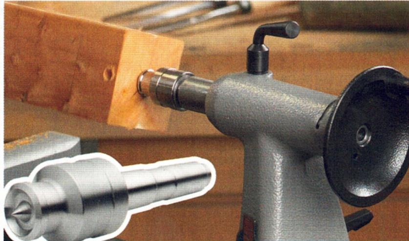
Diese Ringspitze ist mit zwei hochwertigen, dauergeschmierten Lagern ausgestattet, die eine extrem gleichmäßige Rotation ermöglichen. Die Ringkonstruktion bietet eine größere Kontaktfläche als bei herkömmlichen Zentrierspitzen und somit einen besseren Halt. Dadurch ist sie ideal für kleine oder spröde Hölzer und eignet sich sehr gut für Rohlinge mit weichen Jahresringen, da sie beiden Holzstücken auf beiden Seiten der Verbindung starken Halt bietet.
